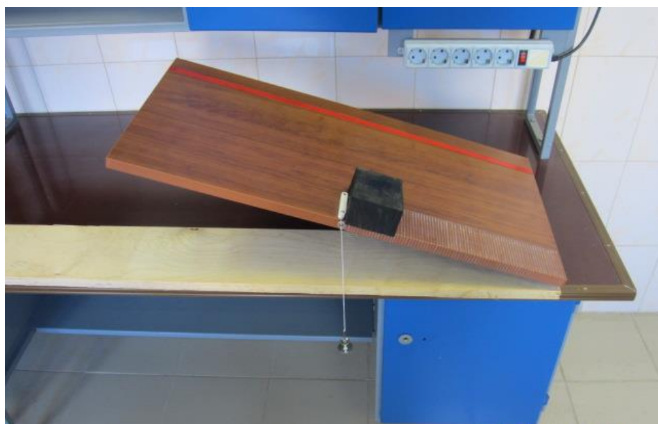
Рисунок 3.4 – Установка для определения коэффициента трения
